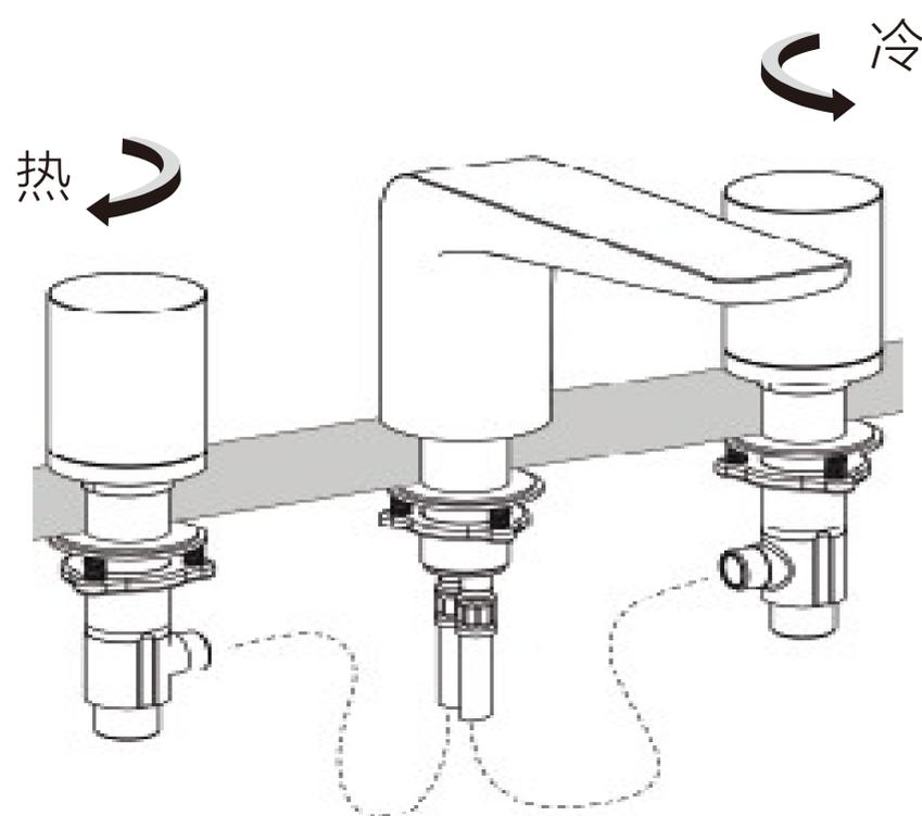
注：开启角阀开关，检查各个部件是否出现漏水现象；按图示方向旋转左右把手，检测冷热水是否正常。
